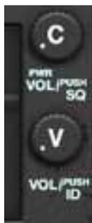
Pousser le bouton C pour régler le squelch de la fréquence COM active, et le tourner pour agir sur son volume.
