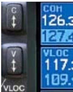
Agir sur les fréquences depuis le GPS les reporte sur les instruments de radio nav et inversement.
