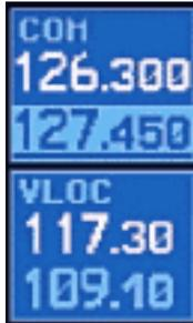
Aussi bien pour COM que pour NAV, la fréquence active est celle du cadre supérieur (en blanc) et la fréquence recherchée (en stand-by, en bleu clair) celle du cadre inférieur.
